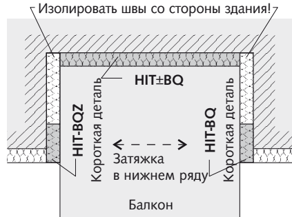
Илл. 3: Внутренний балкон / лоджия, с 3-сторонней опорой, частично выступающий, с затяжкой и поперечными усилиями наверх. Лоджия с затяжкой в нижнем ряду.
